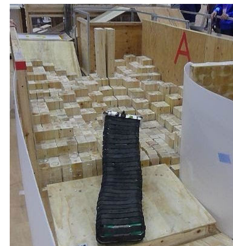
STM (ASTM E2828-11 対称ステップフィールド)
