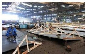
造船会社での線状加熱作業
